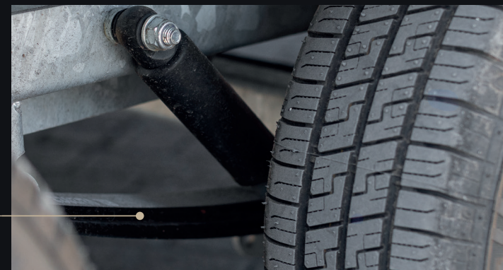
Standaard voorzien van rubber geveerde KNOTT assen. Optioneel verkrijgbaar met zwaardere assen of paraboolvering (standaard met schokbrekers).
